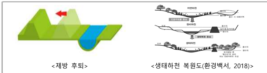
<그림 4-50> 하안 확대 및 제방 후퇴 개념
