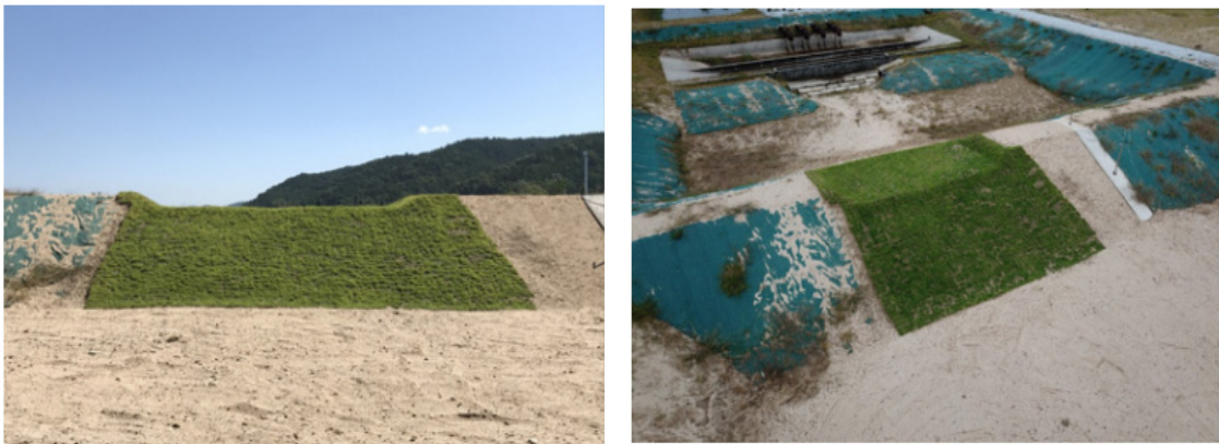
〈그림 5-16〉 한국건설기술연구원 안동하천실험센터 바이오폴리머 제방 실험 전경
