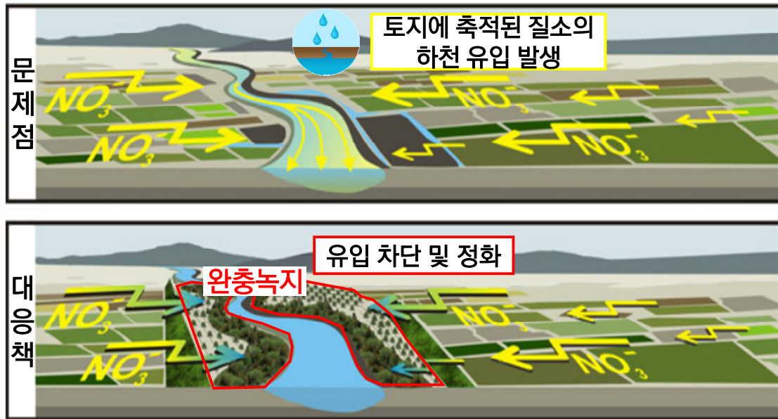
〈그림 5-3〉 수변완충 녹지 조성에 의한 하천 내 질소 유입 저감 개념도
